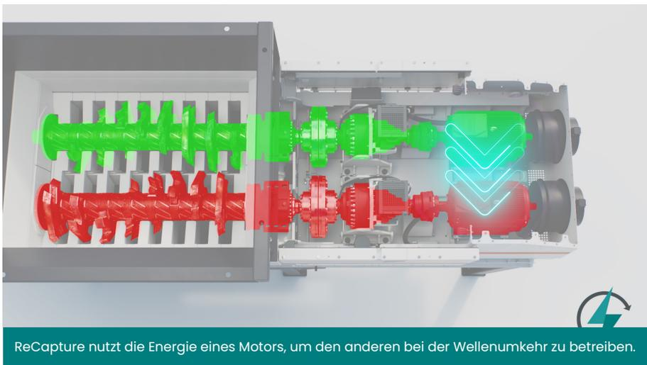
Entwickelt von den Experten von M&J, nutzt ReCapture intelligent die Energie von einem Motor, um den anderen bei der Wellenumkehr zu betreiben, und trägt so bis zu 25 % zu den Energieeinsparungen des M&J e-Drives bei – bestätigt durch Tests vor Ort.
